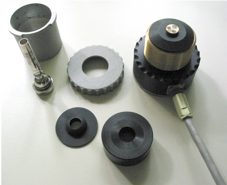
Figure A.2 Photo du système BIAS. La partie principale est à droite. On distingue sur le dessus, les trous des 3 capillaires. A gauche se trouve des pièces d'adaptation. Figure empruntée à [Kausel, 2003].
